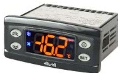
Les régulateurs de la série ID PLUS sont des régulateurs nouvelle génération, dotés d'un nouveau design et d'un paramétrage simplifié. Les ID PLUS971 et ID PLUS974 contrôlent la température d'ambiance d'une enceinte réfrigérée ainsi que la fin du dégivrage grâce à une deuxième sonde. Ils disposent pour cela d'une sortie relais pour réguler le froid et une pour les résistances de dégivrage. Le ID PLUS974 dispose d'une troisième sortie relais pour la gestion de la ventilation.
